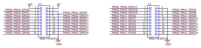
Figure 3-8. BoosterPack<sup>™</sup> Header Pinout
