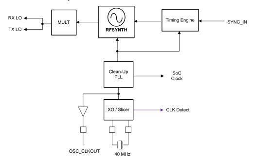
Figure 8-1. Clock Subsystem
