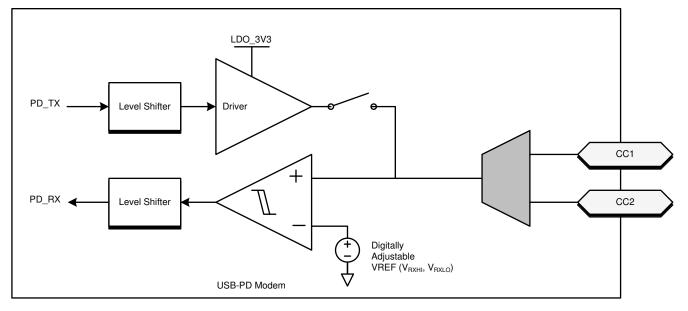
Figure 8-7. USB-PD BMC TX/Rx Block Diagram
