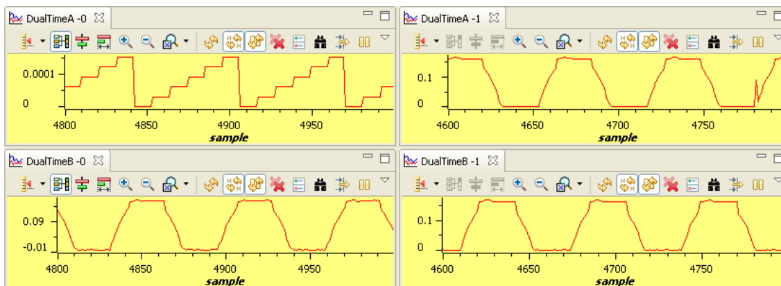
图 30. (a) mod6 计数器, (b) BmfA, (c) BmfB (c)BmfC (无负载, 速度 0.25pu 时, Vdcbus = 160V)
