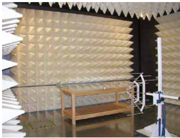
图 1：采用特殊的锥形瓷砖以阻止反射的典型测试室
