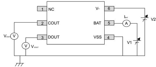
图 7-4. Test Circuit 2
