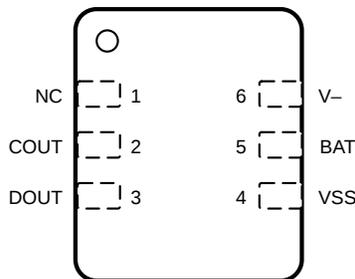
图 5-1. DSE Package 6-PIN WSON Top View
