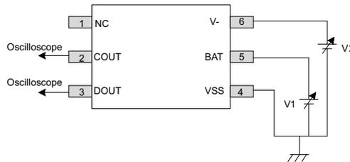
图 7-7. Test Circuit 5
