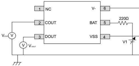
图 7-3. Test Circuit 1
