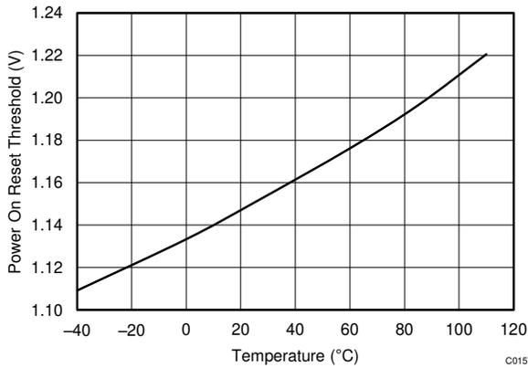
图 6-15. Power On Reset Versus Temperature
