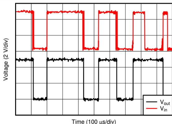
图 9-2. 无 RC 去抖的电路响应
