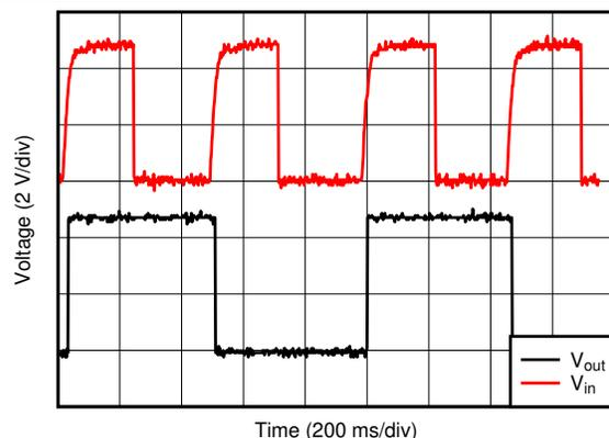
图 9-3. 有 RC 去抖的电路响应  $V_{in} := \text{CLK}$  输入,
