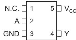
图 4-3. DRL 封装 5 引脚 SOT-5X3 顶视图
