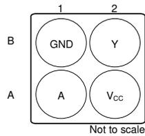
图 4-8. YZV 封装 4 引脚 DSBGA 底视图
