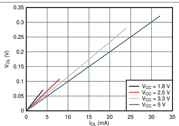
图 5-2. V<sub>OL</sub> 与 I<sub>OL</sub> 间的典型关系 - 25°C
