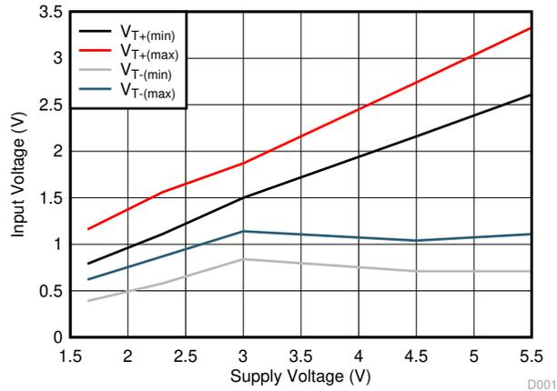
图 7-2. 内插阈值电压与 V<sub>CC</sub> 间的关系
