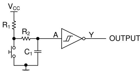
图 7-1. 按钮去抖电路原理图
