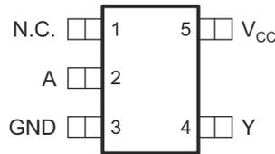
图 4-2. DCK 封装 5 引脚 SC70 顶视图
