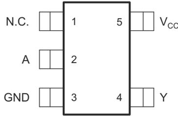
图 4-1. DBV 封装 5 引脚 SOT-23 顶视图
