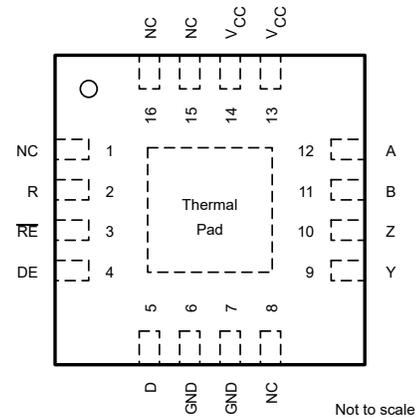
图 5-2. RSA Package (QFN)
