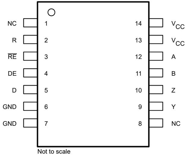
图 5-1. D OR N Package (SOIC)
