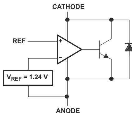
图 7-1. Equivalent Schematic
