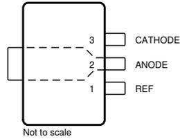
图 4-6. TLVH431 PK Package 3-Pin SOT-89 Top View
