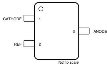
**图 4-5. TLVH432 DBZ Package 3-Pin SOT-23 Top View**
