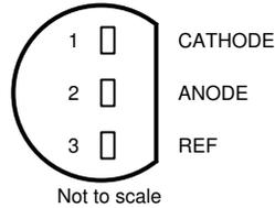
**图 4-3. TLVH431 LP Package 3-Pin TO-92 Top View**
