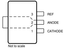
图 4-7. TLVH432 PK Package 3-Pin SOT-89 Top View
