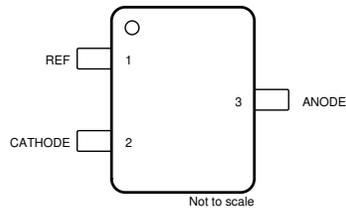
**图 4-4. TLVH431 DBZ Package 3-Pin SOT-23 Top View**
