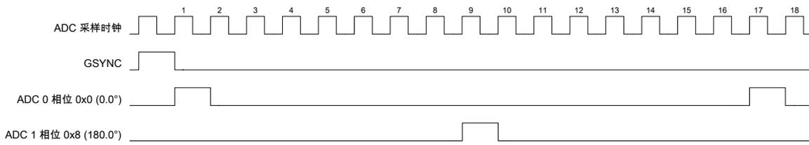
使用 ADCSPC 寄存器，ADC0 和 ADC1 还能实现许多有趣的应用：
