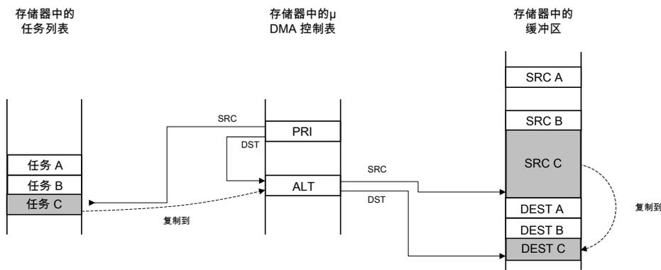
μDMA 控制器按照通道的主控制结构体工作，将任务 C 的配置复制到通道的副控制结构体中。
