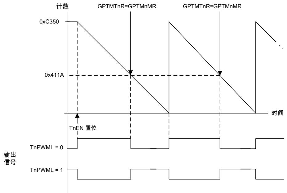
使用 GPTMSYNC 寄存器同步定时器时，定时器必须进行适当配置，以避免在 CCP 输出上出现故障。GPTMTnMR 寄存器的 PLO 和 MRSU 位必须置位。图 11-6 (648 页) 显示在 PLO 和 MRSU 位被置位并且 GPTMTnMATCHR 值大于 GPTMTnILR 值时，CCP 输出如何操作。
