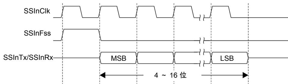
在此模式中，当 SSI 模块处于空闲状态时，SSInClk 和 SSInFss 强制拉低，SSI 发送数据管脚 SSInTx 被置为三态。一旦发送 FIFO 的底部入口包含数据，SSInFss 就会变为高电平并持续一个 SSInClk 周期。要发送的值也从发送 FIFO 传输到发送逻辑的串行移位寄存器中。在下一个 SSInClk 时钟上升沿，数据帧（长度为 4 到 16 位）的最高有效位移位输出到 SSInTx 管脚上。同样，接收到的数据的 MSB 也通过片外串行从器件移到 SSInRx 管脚上。
