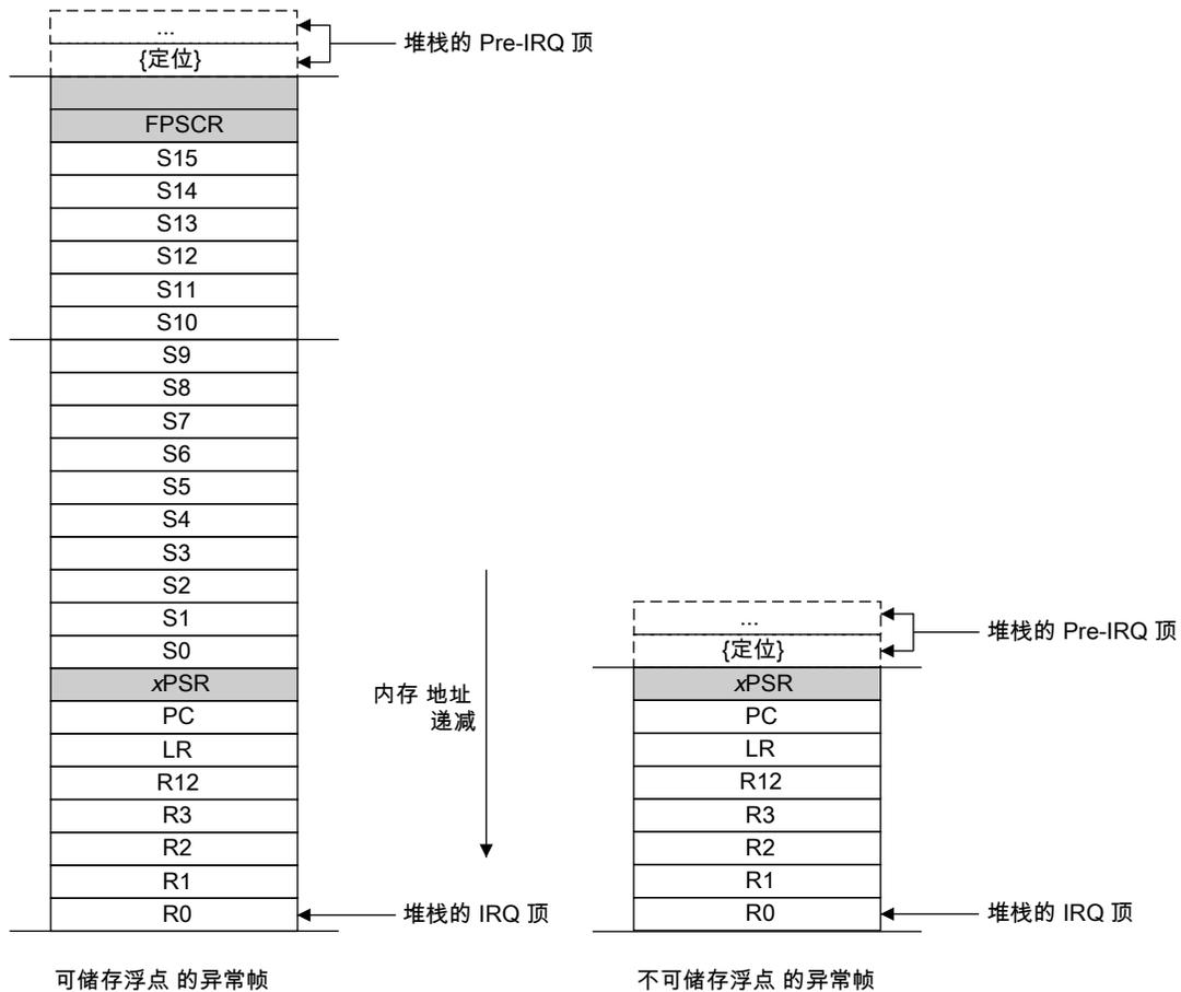
入栈操作完成后，堆栈指针立即指示堆栈框的最低地址。
