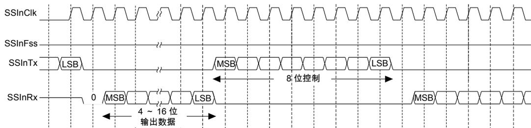
在 MICROWIRE 模式中，当 SSInClk 变为低电平之后，SSI 从机在 SSInFss 的上升沿时刻对接收数据的第一个位进行采样。用来驱动自由运行的 SSInClk 的主机必须确保 SSInFss 信号相对于 SSInClk 的上升沿具有足够的建立时间和保持时间裕量。
