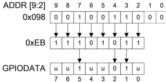
在读操作过程中，如果与数据位相关联的地址位被置位，那么就可以读取到数据寄存器里的值。如果与数据位相关联的地址位被清零，那么不管数据寄存器里实际值是什么都读做 0。例如，读取地址 GPIODATA+0x0C4 处的值，结果如图 10-4 所示。该示例演示了如何读取 GPIODATA 的位 5、4 和 0。
