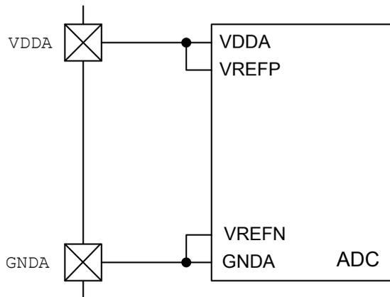
转换值的范围为 0x000~0xFFFF。在单端输入模式下，0x000 对应于 VREFN 上的电平；0xFFFF 对应于 VREFP 上的电平。通过这样的配置，分辨率就可以使用以下等式计算：
