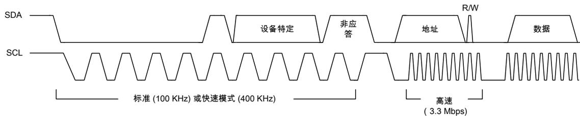
注意：高速模式为 3.4 Mbps，条件是设置了正确的系统时钟频率，且 SCL 和 SDA 线具有适当拉力。
