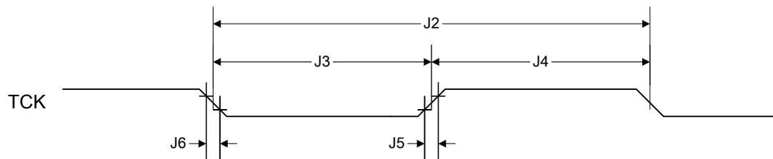
图 22-3. JTAG Test Access Port (TAP) Timing
