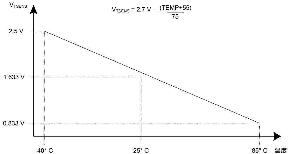
通过将 ADCSSCTLn 中的 TS<sub>n</sub> 位置位，即可在采样队列中得到温度感应器的读数。也可以从温度传感器的ADC结果通过函数转换得到温度读数。以下公式根据 ADC 读数 (ADC<sub>CODE</sub>，定义为 0 至 4095 的一个不带正负号的十进制数) 和最大的 ADC 电压范围 (VREFP-VREFN) 计算温度 (TEMP，单位 °C)：
