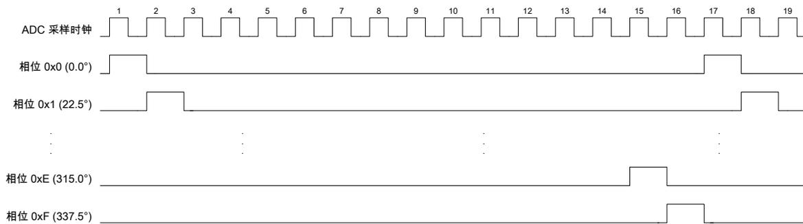
借助此功能可让单个输入通道实现双倍采样率。将 ADC0 和 ADC1 模块配置为采用同一个输入通道，ADC0 模块可以按照标准相位采样（ADCSPC 寄存器的 PHASE = 0）。ADC1 模块可以配置为延后  $180^\circ$  相位采样（PHASE = 0x8）。通过 ADC 处理器采样序列启动 (ADCPSSI) 寄存器的 GSYNC 和 SYNCWAIT 位可以将两个模块配置位同步运行。然后由软件将来自两个模块的结果数据进行组合，就能在 16 MHz（参见图 13-4（729 页））工作频率下实现 1M 的采样率。
