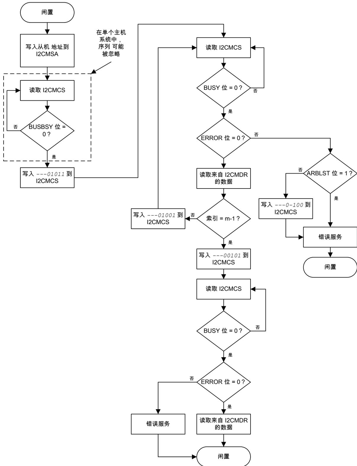
图 16-12. 主机传输后以重复开始序列进行的主机接收
