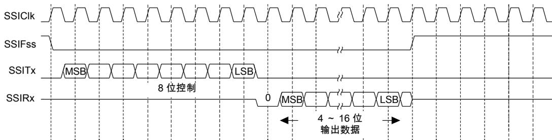
MICROWIRE的帧格式与SPI非常相近，区别之处在于MICROWIRE是半双工而非全双工，而且还采用了主-从报文传递技术。每次串行传输都由 SSI 向片外从器件发送 8 位控制字开始。在此传输过程中，SSI 不会接收到输入的数据。当控制字发送结束（8 位的最后 1 位发送完成）后，片外从设备即对控制字进行译码。总线等待 1 个时钟周期之后，片外从设备开始以所请求的数据应答，应答数据长度为 4 位到 16 位，于是单次会话的总帧长为 13 位到 25 位。
