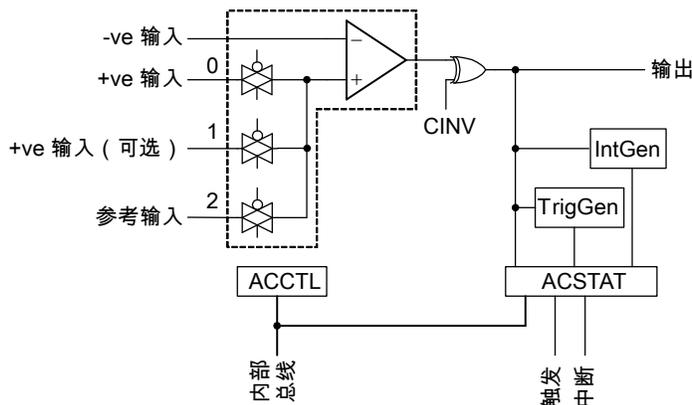
比较器通过模拟比较器控制 (ACCTL) 和模拟比较器状态 (ACSTAT) 这两个状态/控制寄存器来配置。内部参考源通过模拟比较器参考电压控制 (ACREFCTL) 寄存器进行配置。中断状态和控制通过模拟比较器屏蔽中断状态 (ACMIS)、模拟比较器原始中断状态 (ACRIS) 和模拟比较器中断启用 (ACINTEN) 这三个寄存器来控制。
