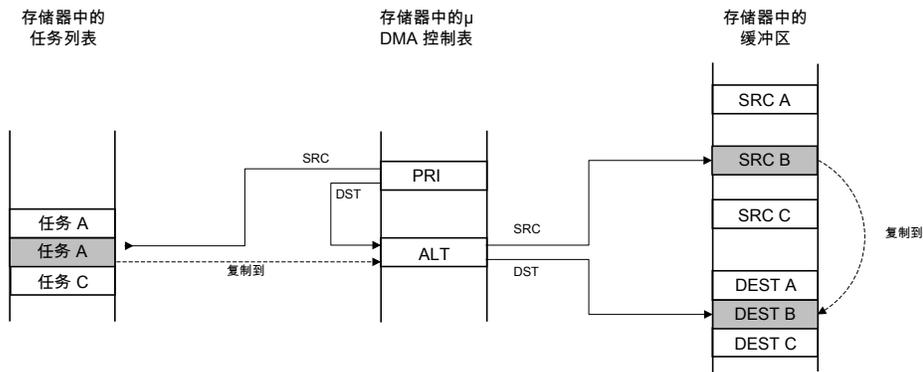
μDMA 控制器按照通道的主控制结构体工作，将任务 B 的配置复制到通道的副控制结构体中。
