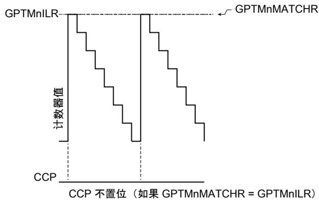
图 11-8 ( 649 页 ) 显示在 PLO 和 MRSU 位被置位并且 GPTMTnILR 大于 GPTMTnMATCHR 值时，CCP 输出如何操作。
