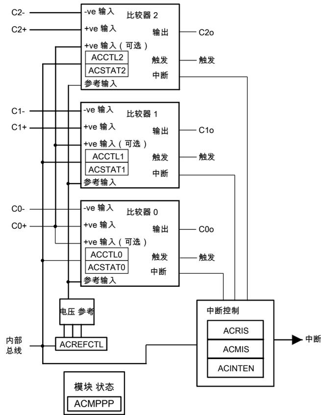
注意：此结构图描述了此微控制器产品系列的模拟比较器以及比较器输出的最大数量。本器件的数量可能有所不同。有关本器件的配置，请参阅1065页。
