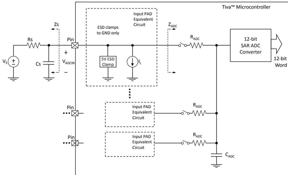
ADC模块同时从3.3V模拟电源和1.2V数字电源取电。在不要求ADC转换精度时，可以将ADC时钟配置为低功耗（请参阅“系统控制”（201页））。模拟信号通过特殊的平衡输入通道连接到ADC，尽量减少输入信号的失真和串扰。关于ADC模块供电及模拟输入的详细信息，请参阅“Analog-to-Digital Converter (ADC)”（1117页）。
