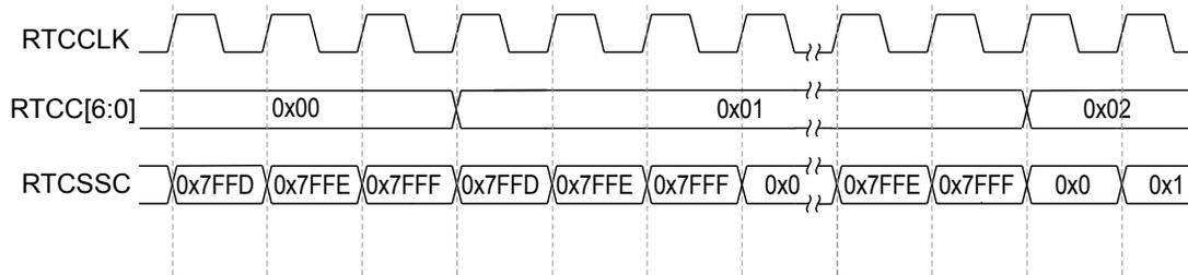
修正值小于 0x7FFF 时，RTCSSC 值从 0x7FFF 增加到修正值，而 RTCC 值从 0x0 增加到 0x1。如果匹配值在该范围以内，匹配中断将不会触发。例如，如图 7-6（442 页）所示，如果 RTCM0=0x1 且 RTCSSM=0x2 时配置匹配中断，绝不会触发中断。
