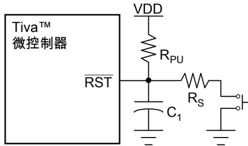
典型  $R_{PU} = 10\text{ k}\Omega$
