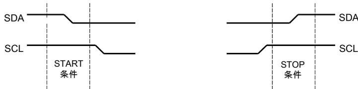
STOP 位决定周期是在数据周期结束时停止，还是继续运行，直到发生重复的 START 条件。要产生单次传输，应在 I<sup>2</sup>C 主机从机地址 (I2CMSA) 寄存器中写入所需的地址，并将 R/S 位清零，在控制寄存器中写入 ACK= X ( 0 或 1 )、STOP= 1、START=1 以及 RUN= 1，以便执行单次传输并停止。操作完成后（或者因为错误退出），中断管脚将激活，数据可能从 I<sup>2</sup>C 主机数据 (I2CMDR) 寄存器中读出。I<sup>2</sup>C 模块以主接收器模式运行时，ACK 位通常会被置位，这会让 I<sup>2</sup>C 总线控制器在每个字节接收完之后自动发送一个应答。当 I<sup>2</sup>C 总线控制器无需接收从发送器发送的数据时，该位必须清零。
