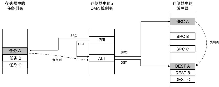
μDMA 控制器按照通道的主控制结构体工作，将任务 A 的配置复制到通道的副控制结构体中。
