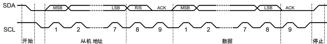
第一字节中的前七位即构成从机地址（请参阅图16-5）。第八位确定报文的方向。R/S位的值为0意味着主机将会传输(发送)数据给选定的从机，如果该位的值为1则表明主机将要将从机那接收数据。
