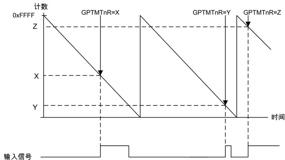
**注意：** 在边沿定时模式下工作时，计数器在启用预分频器时按模  $2^{24}$  计数，在未启用时预分频器时按  $2^{16}$  计数。如果边沿有可能比计数更长，则可执行周期定时器模式中配置的另一定时器，以确保检测到丢失的边沿。周期定时器的配置须确保满足以下条件：
