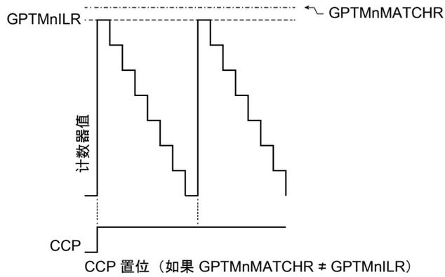
图 11-7 ( 648 页 ) 显示在 PLO 和 MRSU 位被置位并且 GPTMTnMATCHR 值等于 GPTMTnILR 值时，CCP 输出如何操作。此时，如果 PLO 位等于 0，CCP 信号在载入 GPTMTnILR 值时拉高，匹配基本上将被忽略。
