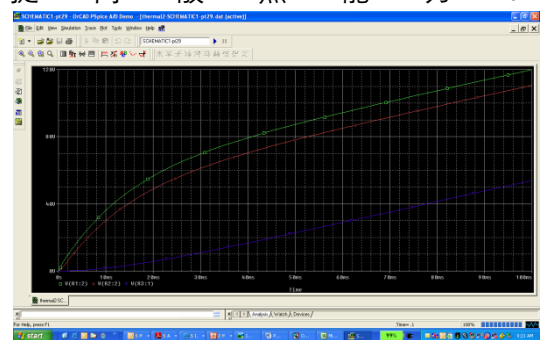
图 2 热能流入 PWB 时明确显示的三个时间恒量
