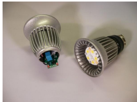
图 1 灯泡替换使电源空间变得极小
