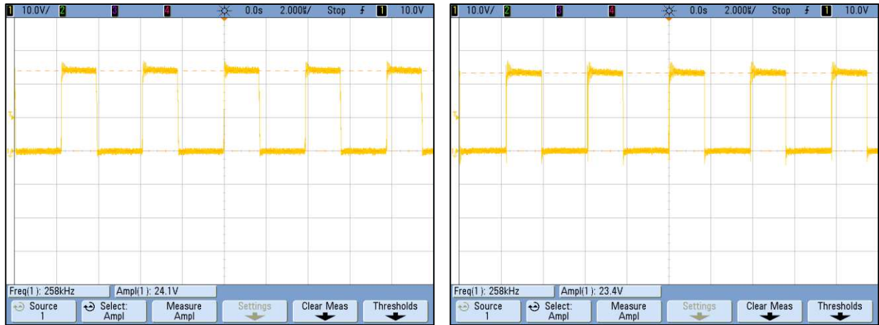
图 12. 24V IN 无负载（左图）和 24V IN 满载（右图）条件下的开关波形
