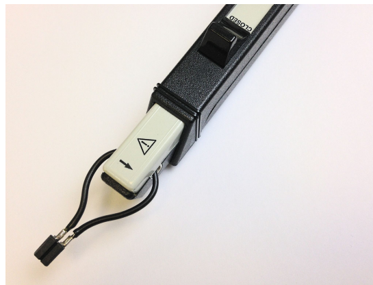
图 21. 电流探针与自制适配器结合用于原边电流测量
