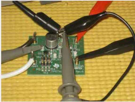
图2 使用示波器探针装置的噪声底限测量
