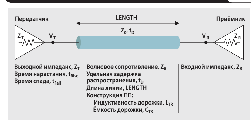
Рис. 3. Пример цепи с несимметричной линией передачи
