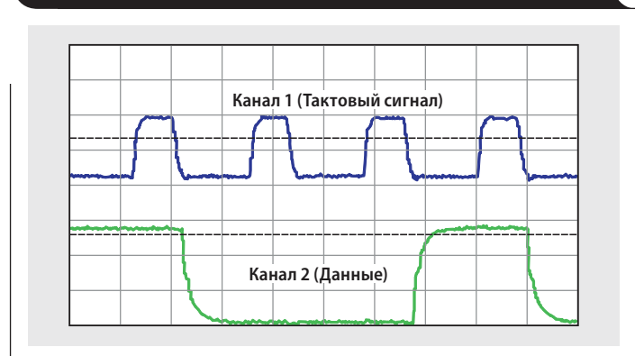
Рис. 8. Стабильные сигналы на плате с согласованными импедансами
