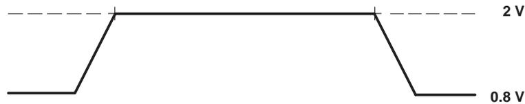
Figure 13. TTL-Level Inputs
