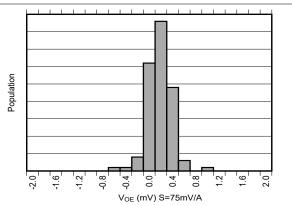
Figure 6-8. Offset Error Production Distribution
