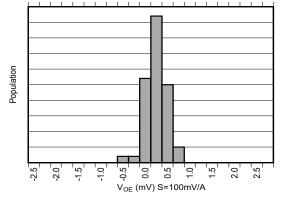
Figure 6-9. Offset Error Production Distribution
