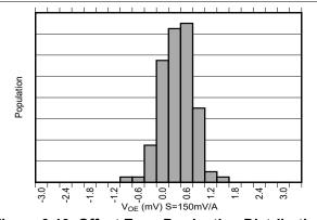
Figure 6-10. Offset Error Production Distribution
