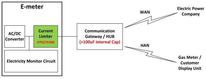
Figure 1. Smart Meter Power Topology
