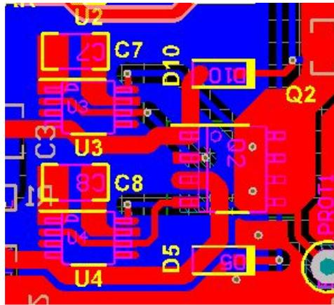
Figure 49. LM74610-Q1 Smart-Reverse Battery-Diode Layout
