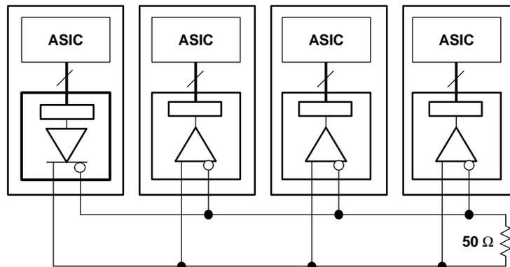
**Figure 21. Multidrop Configuration**
