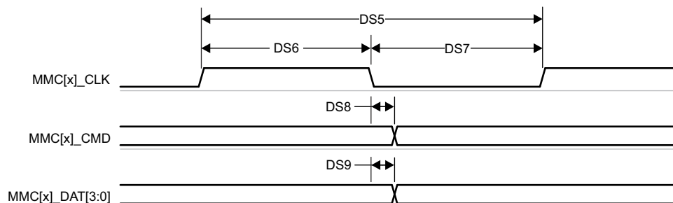
图 7-66. MMC1 - Default Speed - Transmit Mode
