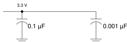
图 9-2. 建议的 LVDS 旁路电容器布局
