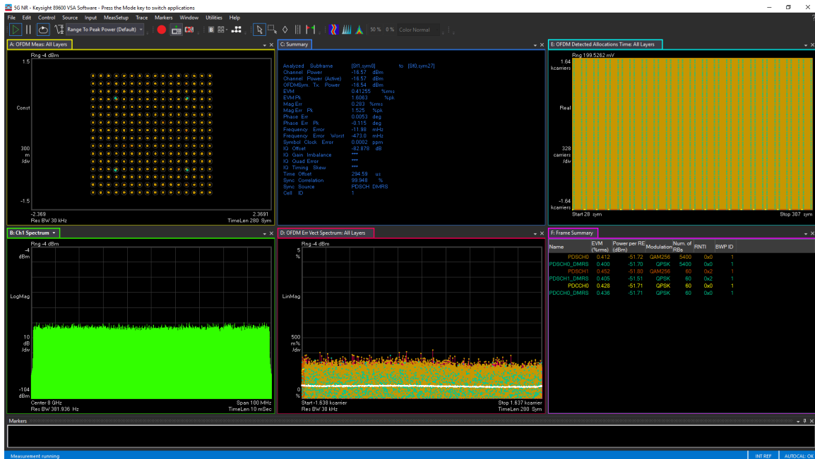
图 6-230. TX 100MHz NR EVM at 8.11 GHz
