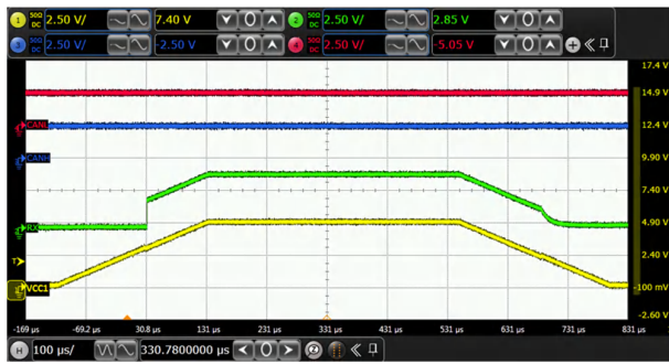
图 6-11. V_{OD(DOM)} Over V_{CC}
