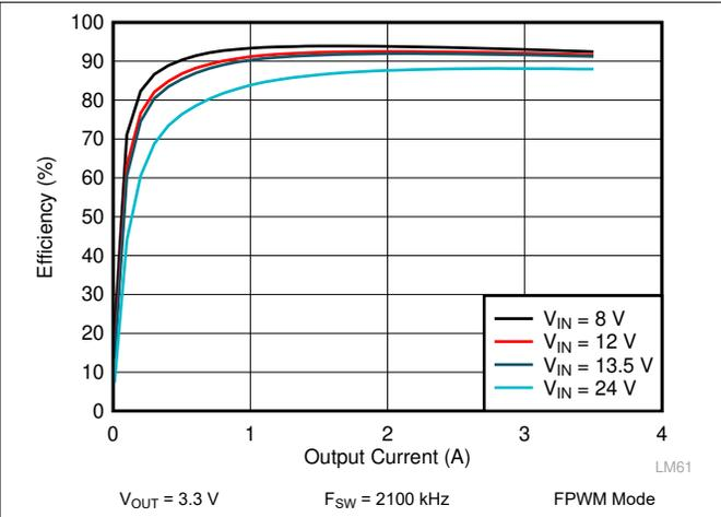
图 9-6. LM62435-Q1 Efficiency
