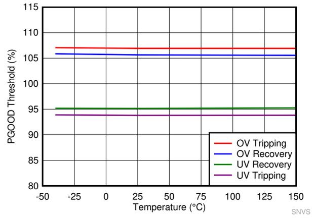
图 7-8. PGOOD Thresholds
