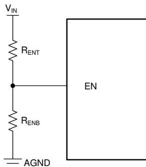
**图 8-1.  $V_{IN}$  UVLO Using the EN pin**
