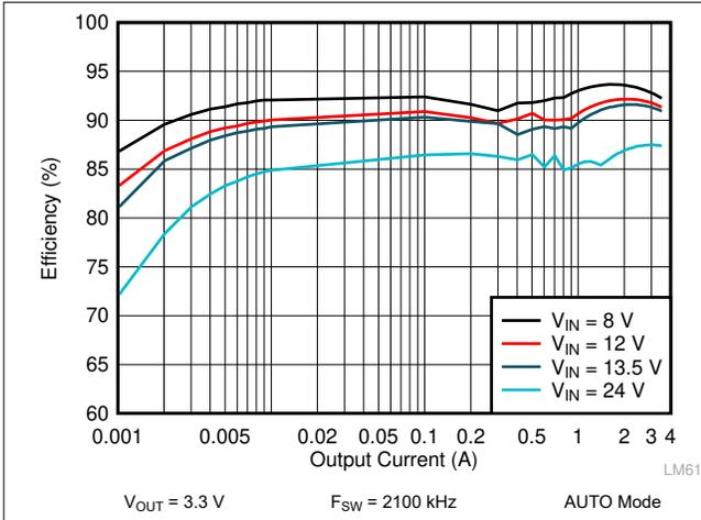
图 9-5. LM62435-Q1 Efficiency
