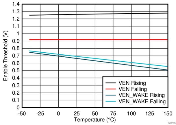
图 7-7. Enable Thresholds
