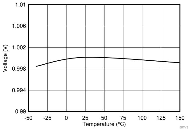
图 7-3. Feedback Voltage
