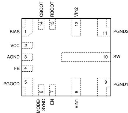
图 6-1. RJR Package 14-Pin VQFN-HR Top View
