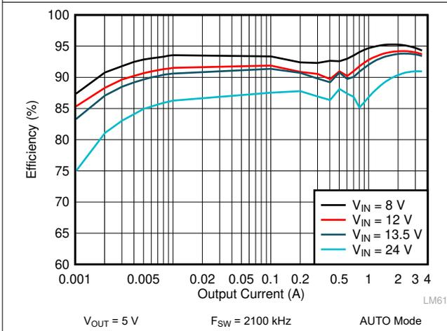
图 9-7. LM62435-Q1 Efficiency
