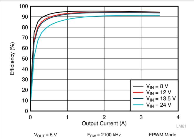
图 9-8. LM62435-Q1 Efficiency
