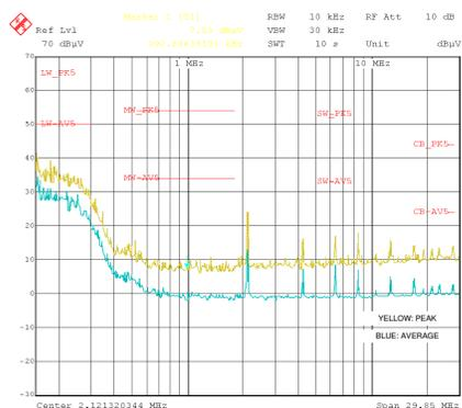
传导 EMI：V<sub>OUT</sub>=5V，f<sub>SW</sub>=2100kHz
