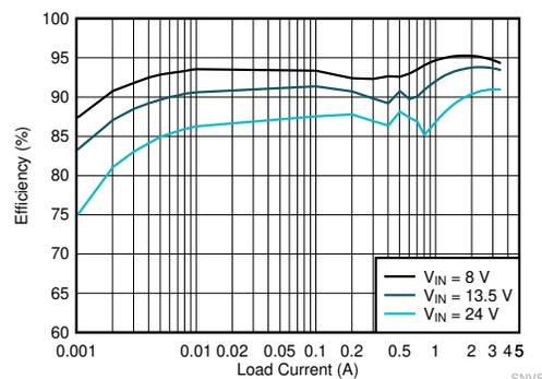
效率：V<sub>OUT</sub> = 5V，f<sub>SW</sub> = 2200kHz
