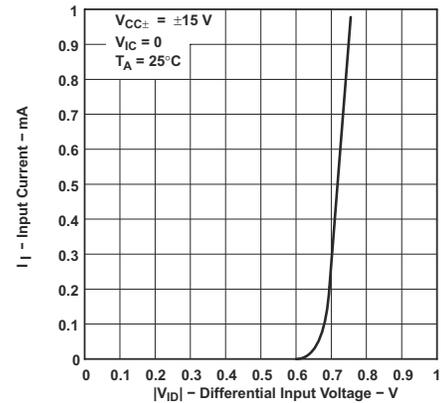
图 6-10. 输入电流与差分输入电压间的关系
