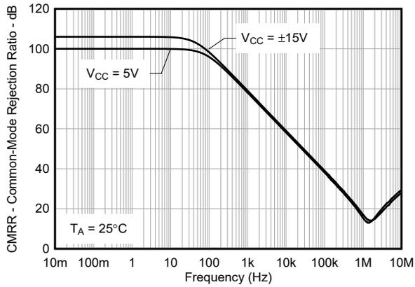
图 6-33. TLE202x 共模抑制比与频率间的关系
