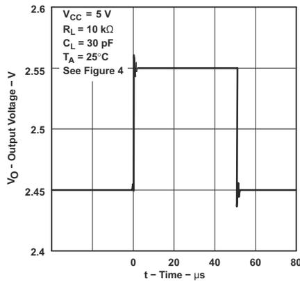
图 6-35. 电压输出器小信号脉冲响应
