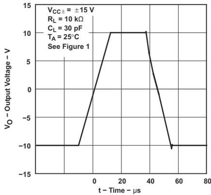
图 6-39. TLE2021 电压输出器大信号脉冲响应
