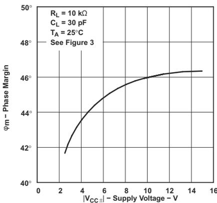
图 6-47. TLE2021 相位裕度与电源电压间的关系
