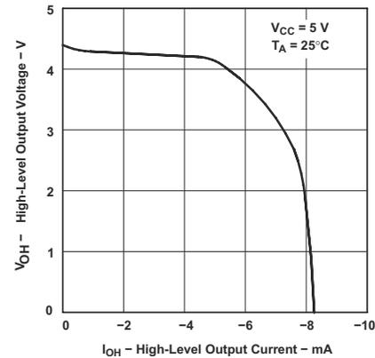
图 6-16. TLE2022 和 TLE2024 高电平输出电压与高电平输出电流间的关系
