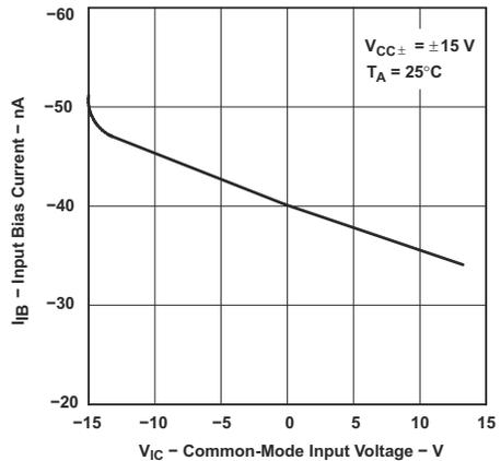
图 6-6. TLE2024 输入偏置电流与共模输入电压间的关系
