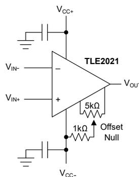
图 7-2. 输入失调电压归零电路
