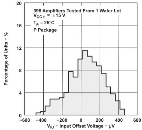
图 6-2. TLE2022 输入偏移电压的分布
