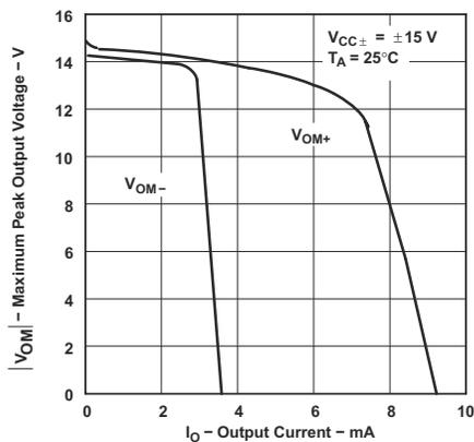
图 6-11. TLE2021 最大峰值输出电压与输出电流间的关系
