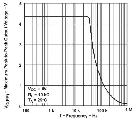
图 6-20. 最大峰值间输出电压与频率间的关系
