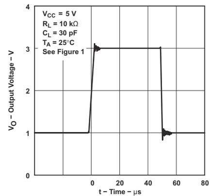
图 6-36. TLE2021 电压输出器大信号脉冲响应
