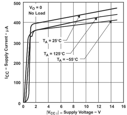
图 6-28. TLE2022 电源电流与电源电压间的关系
