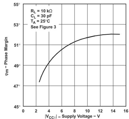
图 6-48. TLE2022 和 TLE2024 相位裕度与电源电压间的关系
