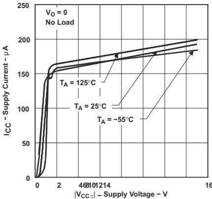
图 6-27. TLE2021 电源电流与电源电压间的关系
