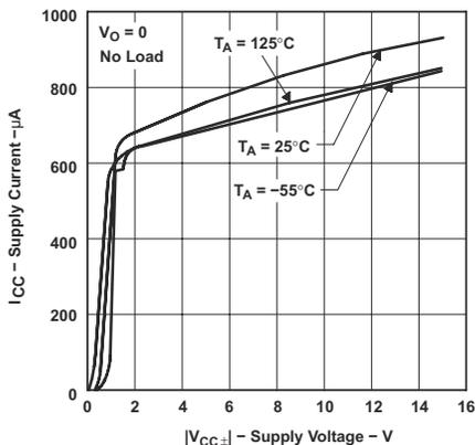
图 6-29. TLE2024 电源电流与电源电压间的关系
