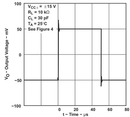
图 6-34. 电压输出器小信号脉冲响应
