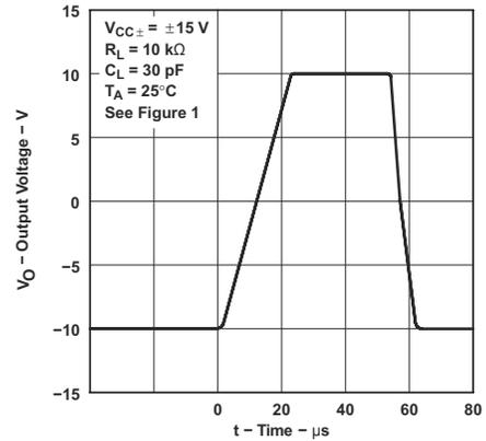
图 6-40. TLE2022 电压输出器大信号脉冲响应
