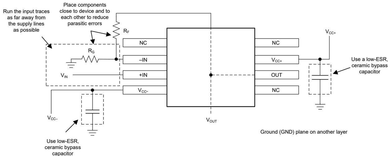
图 7-4. 同相配置的运算放大器电路板布局
