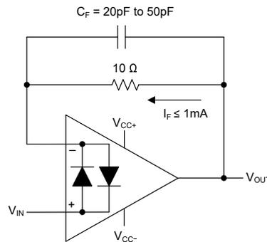
图 7-1. 电压输出器
