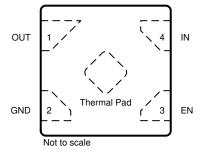
图 5-1. DQN Package, 4-Pin X2SON, Top View
