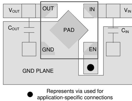
图 10-1. Layout Example for the DQN Package
