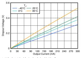
压降电压与输出电流间的关系 (3.3V Vour)
