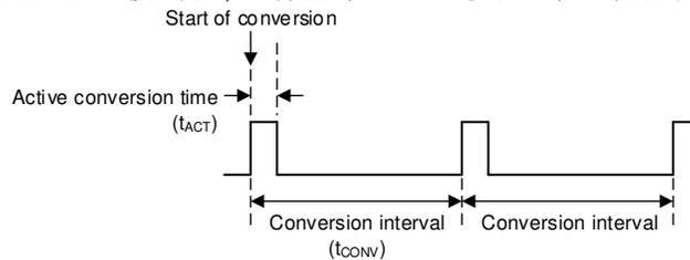
图 7-5. 连续转换时序图
