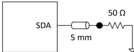
图 6-6. 输出压摆率和输出时序基准负载
