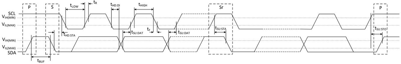
图 6-1. I<sup>2</sup>C 和 I<sup>3</sup>C 基本总线输入时序图
