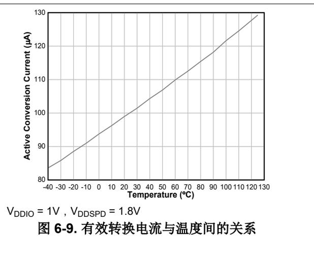
图 6-9. 有效转换电流与温度间的关系
