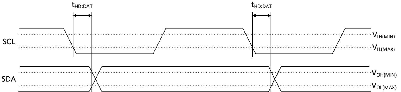
图 6-4. I<sup>2</sup>C 基本总线输出时序图
