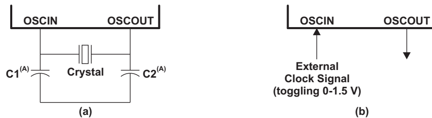
图 5-5. 推荐的晶振/时钟连接
