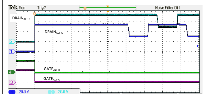
图 124. 由于 4PPCut 故障导致的 4 线对退避
