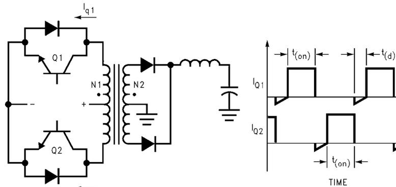
图11. 推挽式转换器
