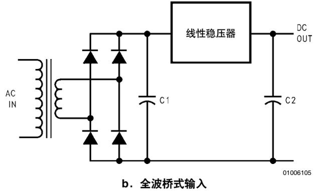
图2. 线性电压稳压器
