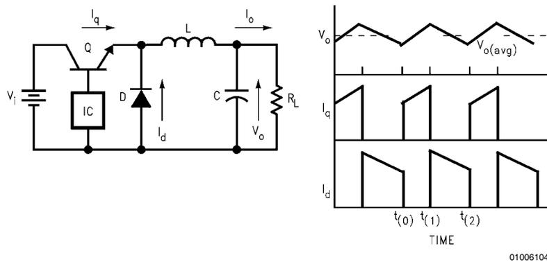
图4. 降压型稳压器及其电压和电流波形
