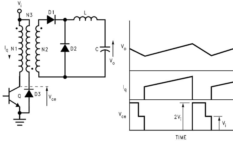
图10. 正激转换器
