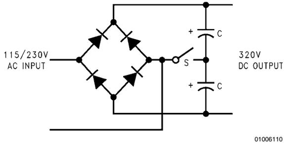
图9. 选择115V/230V输入电压的开关
