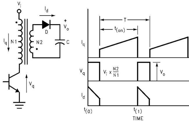
图7. 反激转换器
