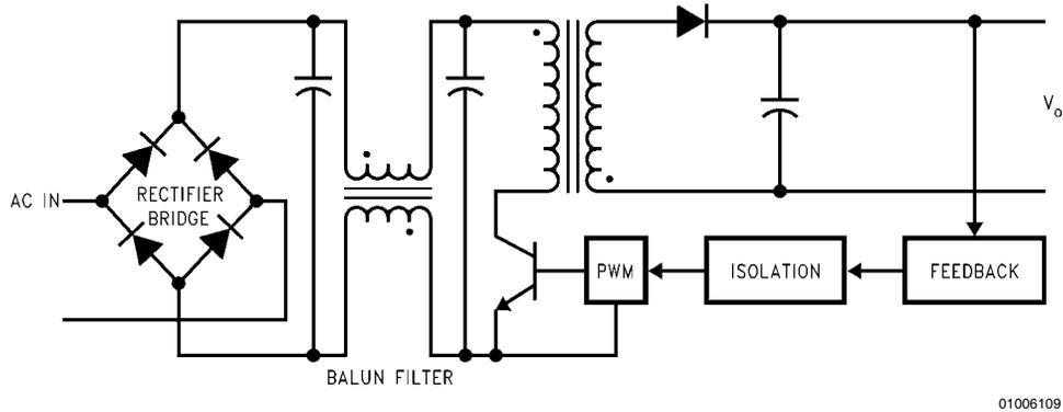
图8. 完整的隔离反激开关电源
