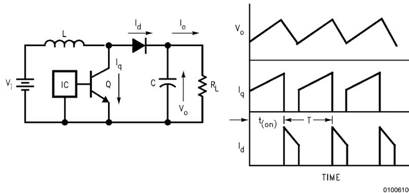
图5. 升压型稳压器和关联的I/V波形
