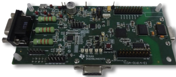
图 2. 多参数前端参考设计。
