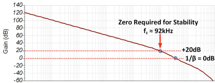
$$R_{ISO} = \frac{1}{2 \cdot \pi \cdot f_z \cdot C_L} = \frac{1}{2 \cdot \pi \cdot 92\text{kHz} \cdot 2.2\text{nF}} = 786 \Omega$$
