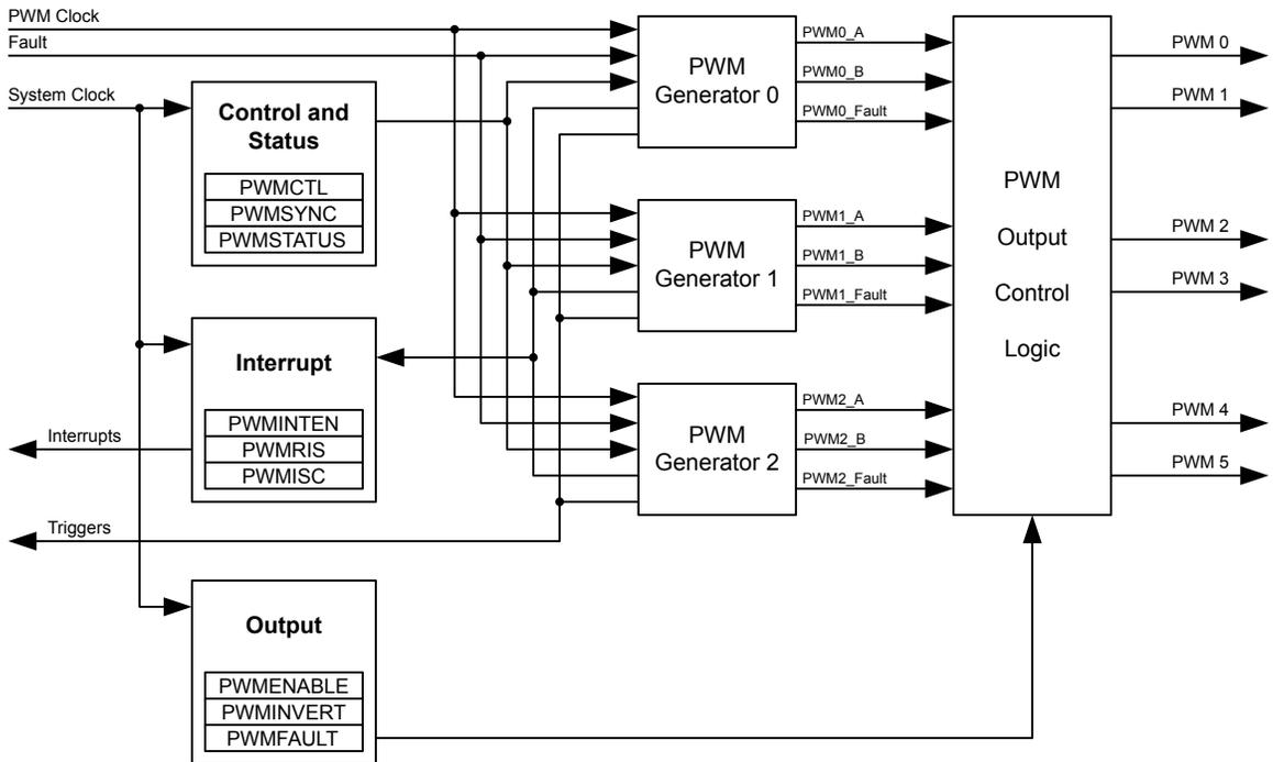
Figure 14-2. PWM Module Block Diagram
