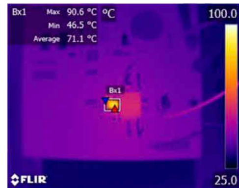
Abbildung 14. Wärmeverhalten des LM60440 mit DAP im Enhanced HotRod QFN-Gehäuse bei einer durchschnittlichen Temperatur von 71,1 °C.
