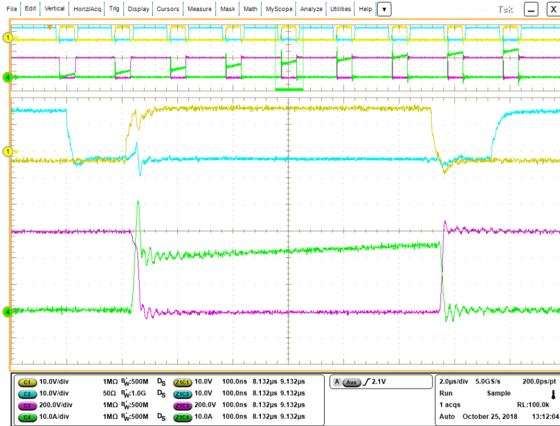
図 8-6. SiC MOSFET のスイッチング波形
