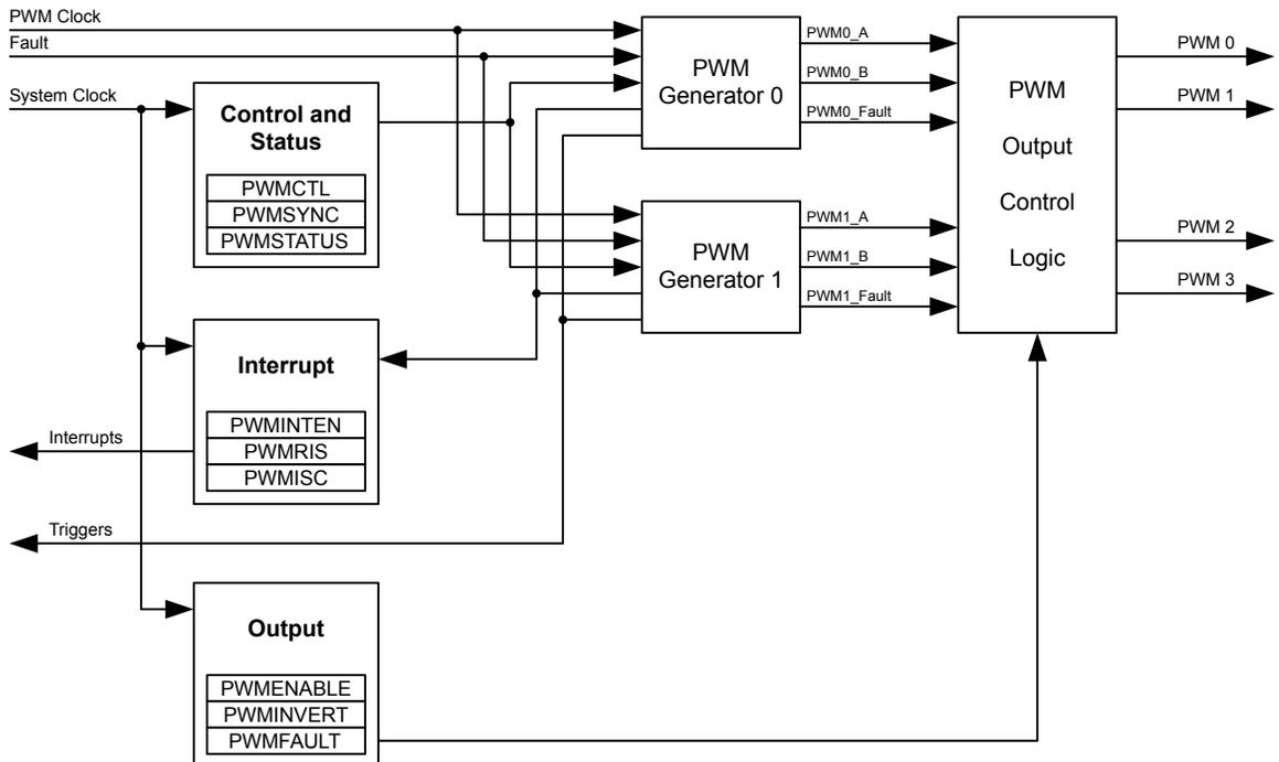
Figure 16-2. PWM Module Block Diagram
