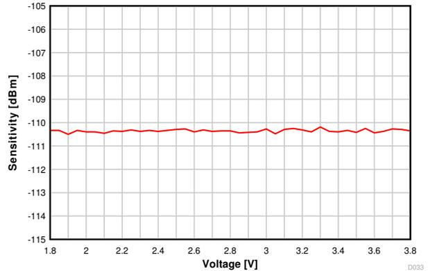
図 7-14. 感度と電源電圧との関係 (VDD5) (50kbps、868.3MHz)
