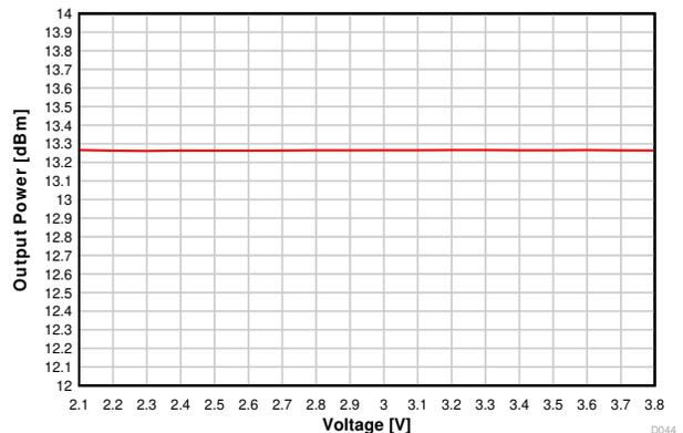
図 7-20. 出力電力と電源電圧との関係 (VDD5)
