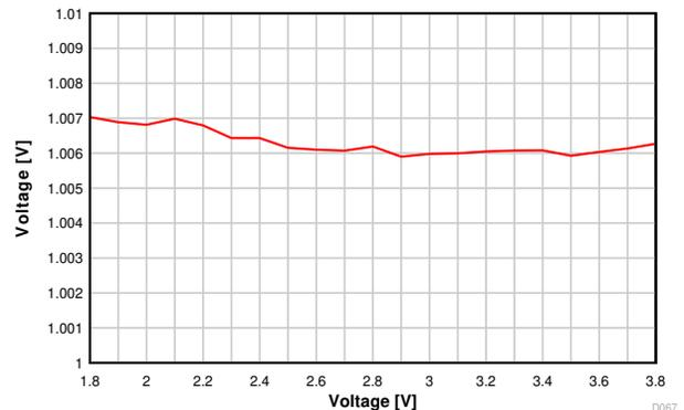
図 7-28. ADC の精度と電源電圧 (VDD) との関係
