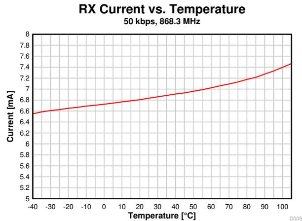
図 7-6. DX 電流と温度との関係 (50kbps、868.3MH)
