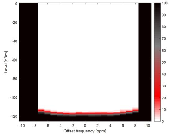
図 7-18. 狭帯域、9.6kbps ± 2.4kHz 偏差、2-GFSK、868MHz、17.1kHz RX 帯域幅
