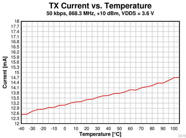
図 7-9. TX 電流と温度との関係 (50kbps、868.3MHz、VDD5 = 3.6V)
