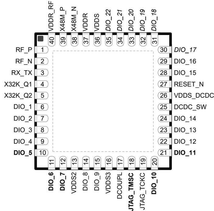
図 6-2. RKP (5mm × 5mm) ピン配置、0.4mm ピッチ (上面図)
