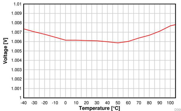
図 7-27. ADC の精度と温度との関係
