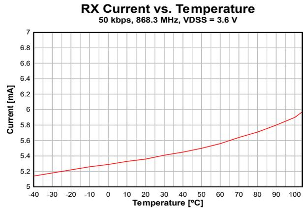
図 7-7. RX 電流と温度との関係 (50kbps、868.3MHz、VDD5 = 3.6V)
