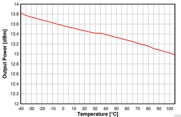
図 7-19. 出力電力と温度との関係 (50kbps、868.3MHz)
