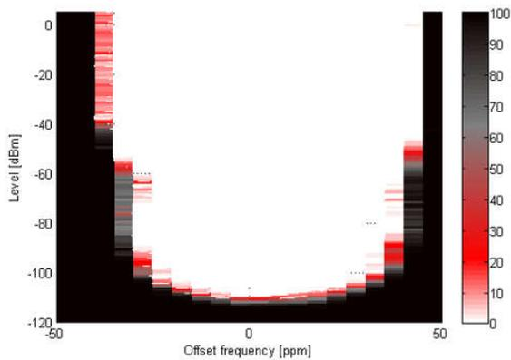
図 7-17. 802.15.4、50kbps、±25kHz の偏差、2-GFSK、100kHz の RX 帯域幅
