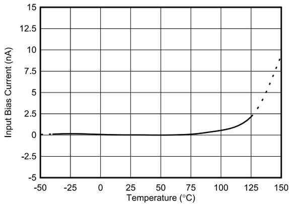
図 6-16. 入力バイアス電流と温度の関係
