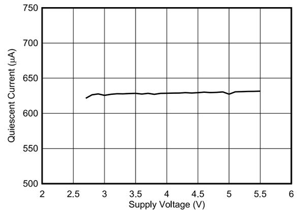
図 6-19. アクティブ  $I_Q$  と電源電圧の関係
