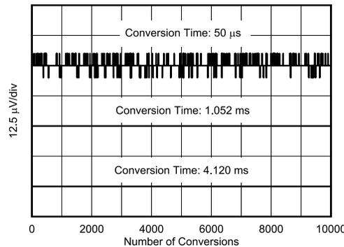
図 7-5. ノイズと変換時間の関係 (平均化 = 128)
