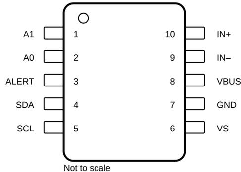
図 5-1. DGS パッケージ 10 ピン VSSOP 上面図
