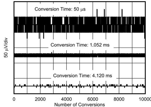
図 7-4. ノイズと変換時間の関係 (平均化 = 1)
