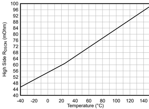
図 6-3. ハイサイド MOSFET の  $R_{DS(ON)}$
