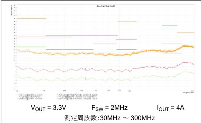
図 8-32. 放射 EMI バイコン水平偏波と CISPR25 制限値との関係、 LMR60440QEVN
