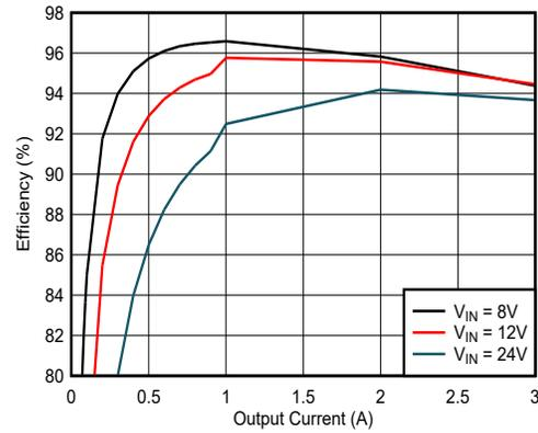
$V_{OUT} = 5V$   $F_{SW} = 400kHz$  モード = FPWM
