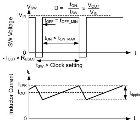
図 7-11. ドロップアウト波形
