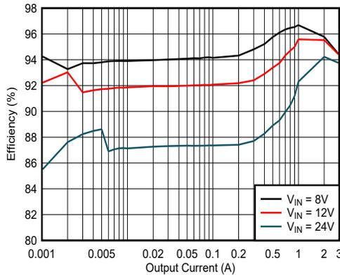
$V_{OUT} = 5V$   $F_{SW} = 400kHz$  モード = 自動
