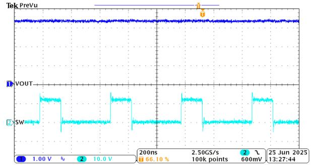
デバイスの種類 = 3A 3.3V 固定出力 モード = 自動
