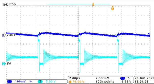
デバイスの種類 = 3A 3.3V 固定出力 モード = 自動
