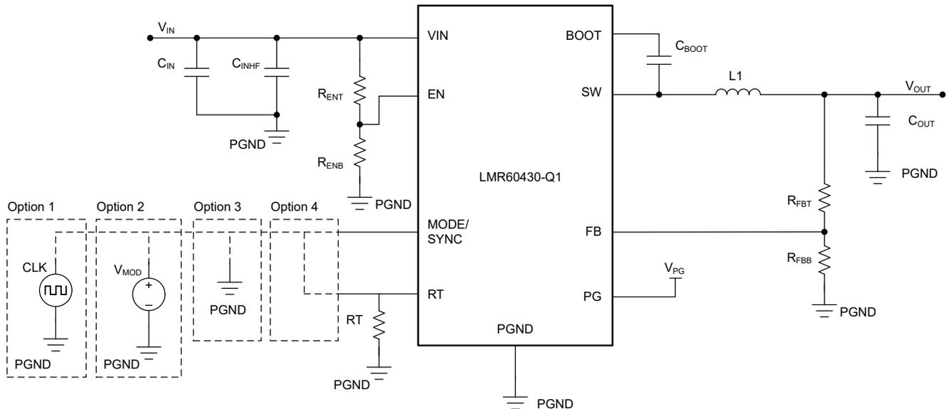
図 8-1. LMR60430-Q1 のリファレンス回路図
