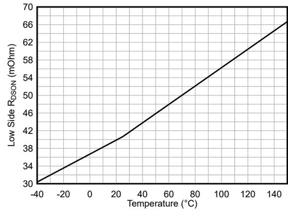
図 6-4. ローサイド MOSFET の  $R_{DS(ON)}$
