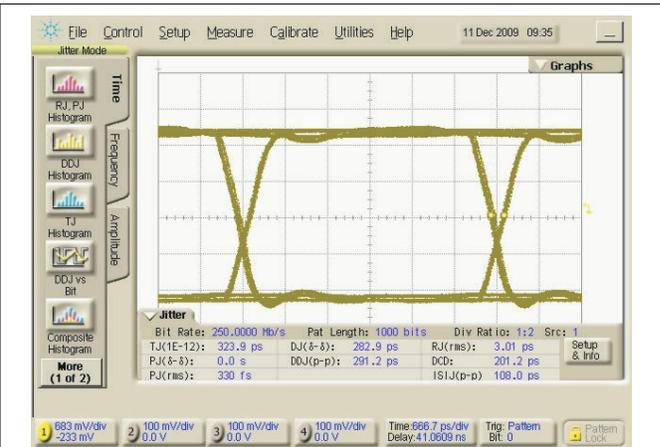
図 5-22. レシーバ出力アイパターン 250Mbps、 $2^{15}-1$  PRBS、 $V_{CC} = 3.3V$   $|V_{ID}| = 800mV_{PP}$ 、 $V_{IC} = 1V$
