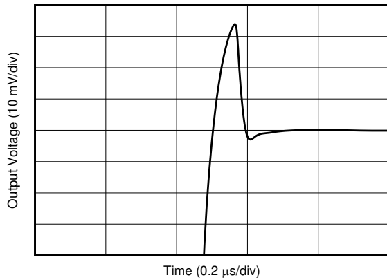
図 7-31. 小信号ステップ応答
