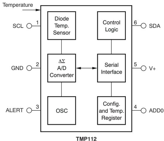
図 7-1. 内部ブロック図 (SOT563-6 パッケージ)
