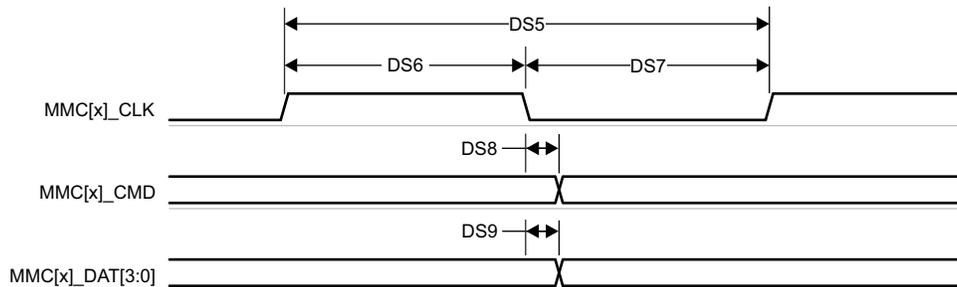
図 7-84. MMC1/MMC2 – デフォルト速度 – 送信モード
