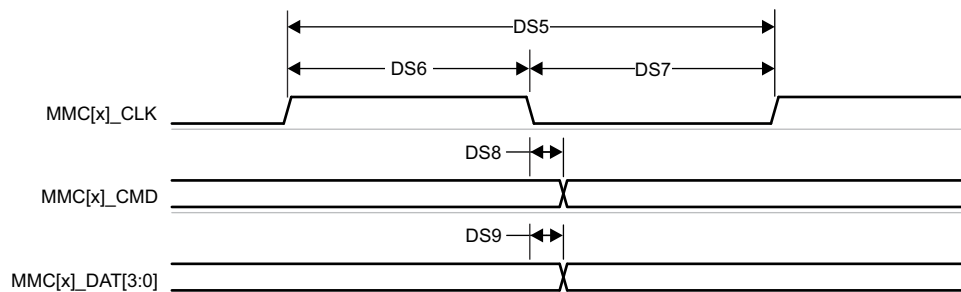
図 6-66. MMC1 – Default Speed – Transmit Mode
