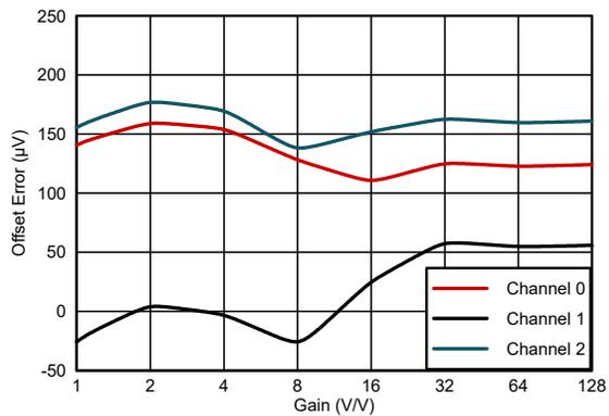
图 6-8. Offset Error vs Gain
