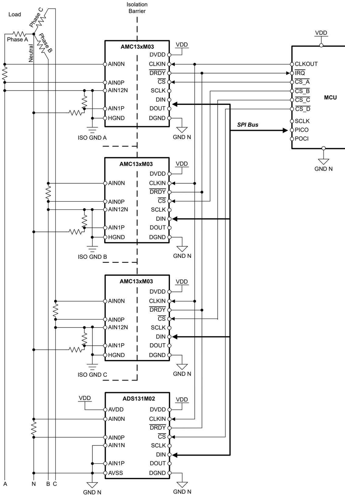
図 9-4. 3-Phase Metrology Design Front-End Using the AMC131M03
