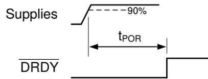
Figure 6-3. Power-On-Reset Timing
