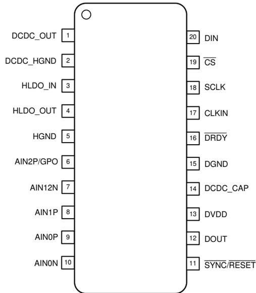
図 5-1. DFM Package, 20-Pin SOIC (Top View)
