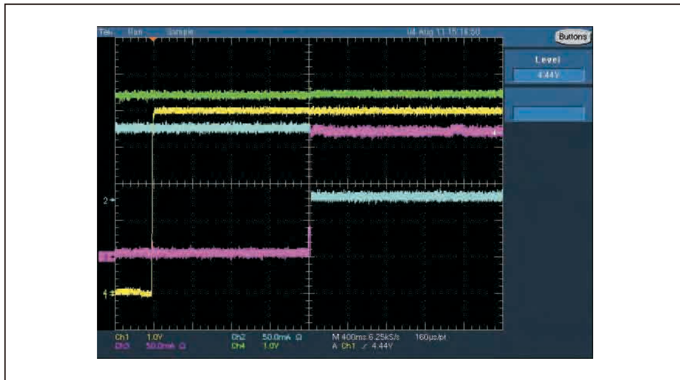
図 3. VBUSからVINへの充電 - デフォルト・モード、CH1 : VIN、CH2 : IVBUS、CH3 : IVIN、CH4 : VBUS
