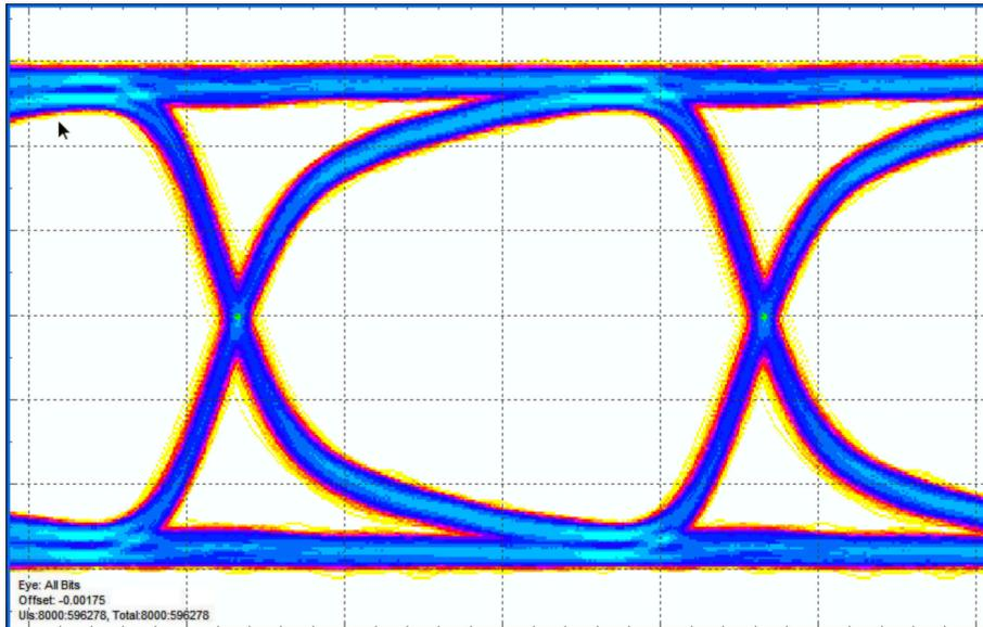
図 5-3. FPD-Link III フォワード チャネル (シリアルライザ出力) のアイ ダイアグラム 垂直スケール: 100mV/DIV、
