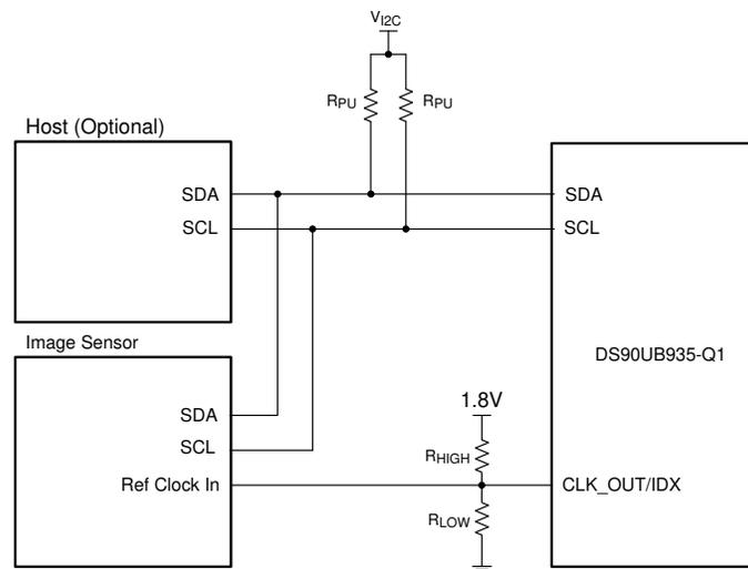
図 6-8. IDX ピンのバイアス回路
