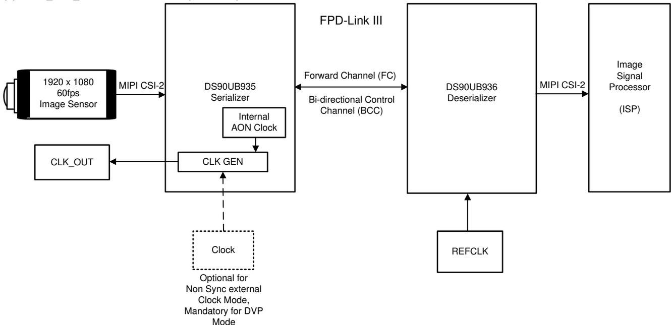
図 6-6. クロッキング供給システムの図
