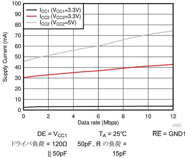
図 7-7. ISO143x の電源電流とデータ レートとの関係
