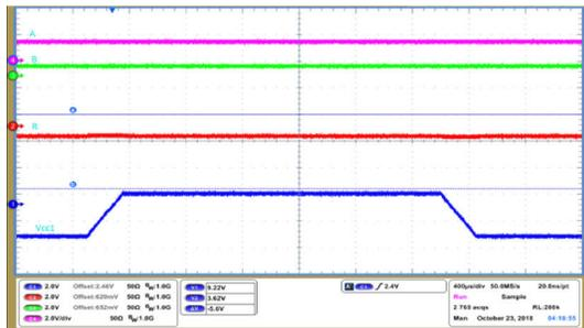
図 7-33.  $V_{CC1}$  パワーアップ/パワーダウン - グリッチフリー動作
