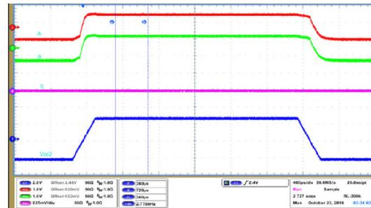
図 7-34.  $V_{CC2}$  パワーアップ/パワーダウン - グリッチフリー動作
