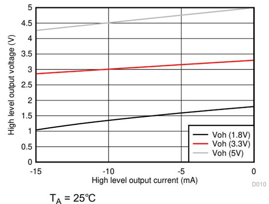
図 7-22. レシーババッファの High レベル出力電圧と High レベル出力電流との関係
