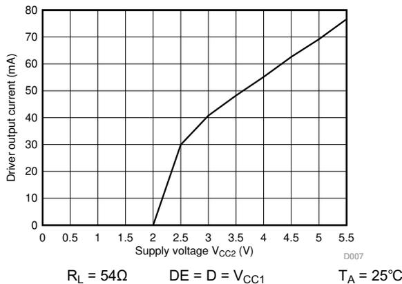
図 7-15. ドライバ出力電流と電源電圧との関係 (V<sub>CC2</sub>)
