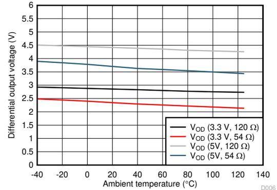
図 7-14. ドライバ差動出力電圧と温度との関係
