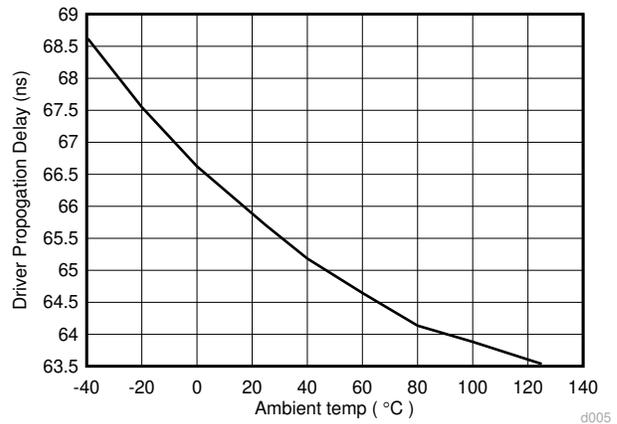
図 7-20. ISO143x ドライバの伝搬遅延 (ns) と温度 (°C) との関係
