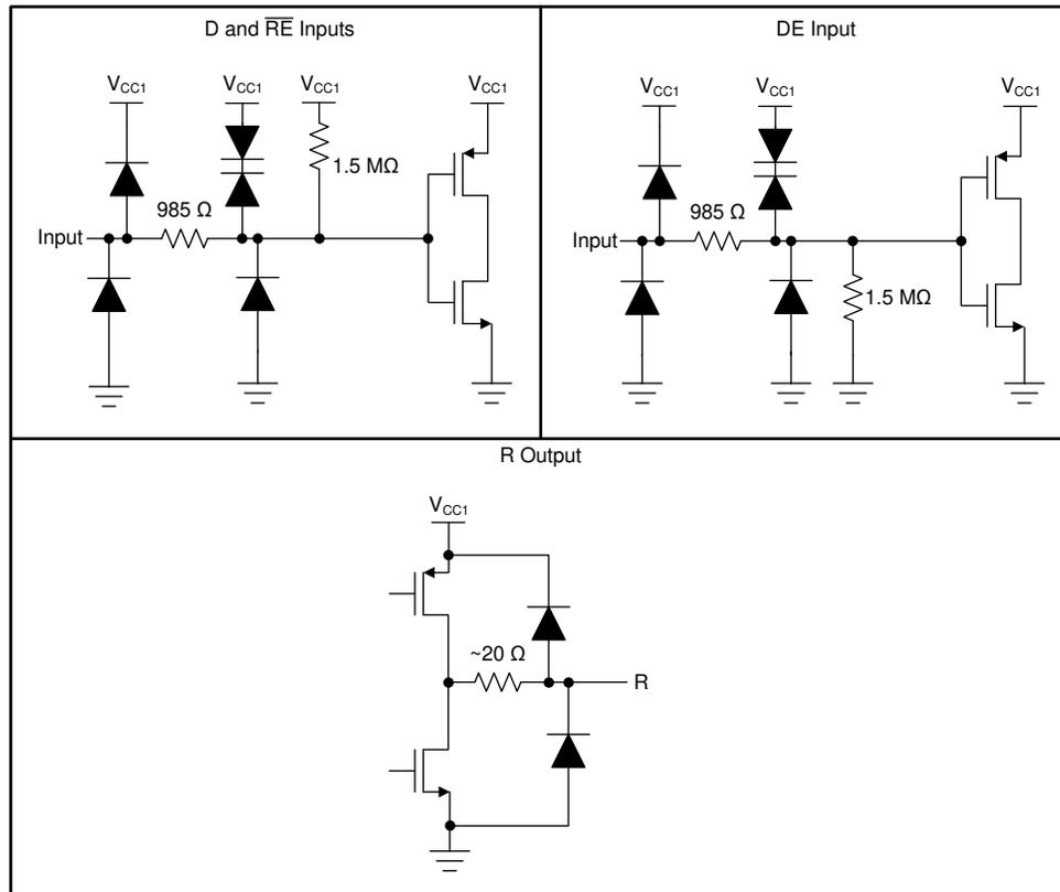
図 9-4. デバイス I/O 回路図
